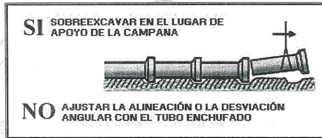
Fig. 11.- Detalle de la campana en tuberías.
