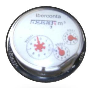
De esta manera para el medidor del extremo derecho; la lectura completa seria de 1555 M3 con 329 litros; pero la lectura que aparecera en su medidor sera de solo 1555 metros cubicos
